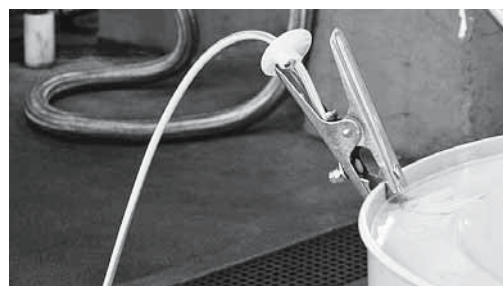
Fig. 2: morsetto di messa a terra collegato a un bordo del fusto.
